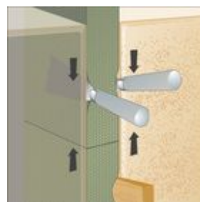
Bild 2: Stumpfstoß im Massivbau
