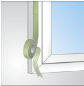
Bild 3: Stumpfstoß bei der Fenstermontage
