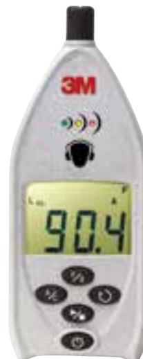
Abb.: 3M™ Schallpegelmessgerät SD-200
