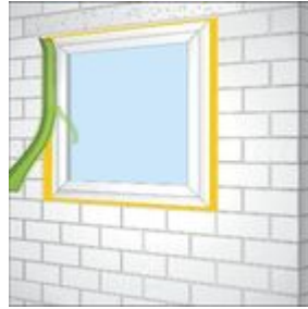
Bild 1: Verklebung mit dem Baukörper
