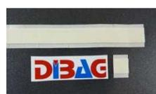
Di-Fix Zuschnitte 7207 bestehen aus einem weissen PE-Schaum, beidseitig mit einer Synthekautschukmasse beschichtet. Diese sind 1-bahnig auf einem Silikonpapier aufgetragen und haben einen beidseitig einen Anfasser.
